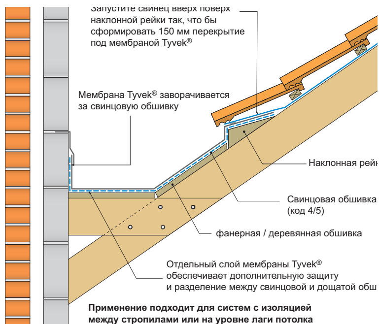
Рис.36 - Неподдерживаемая мембрана поверх стропил
